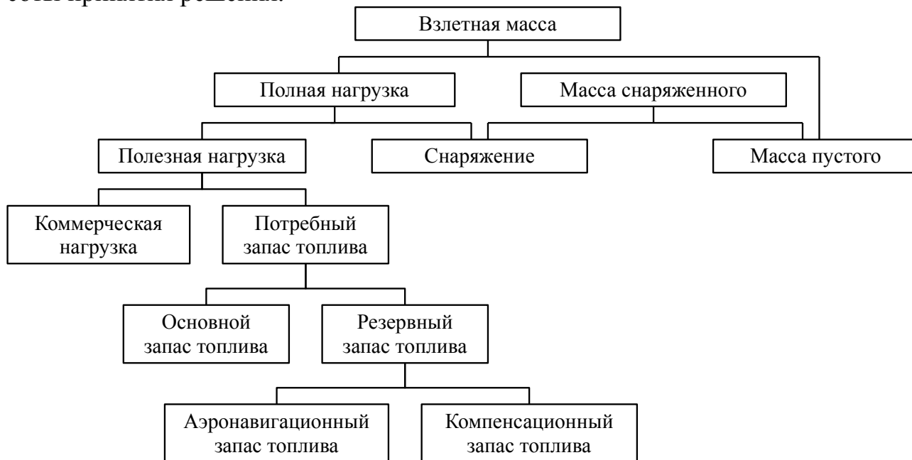
Рис. 1.3 – Взаимосвязь характерных масс летательного аппарата
