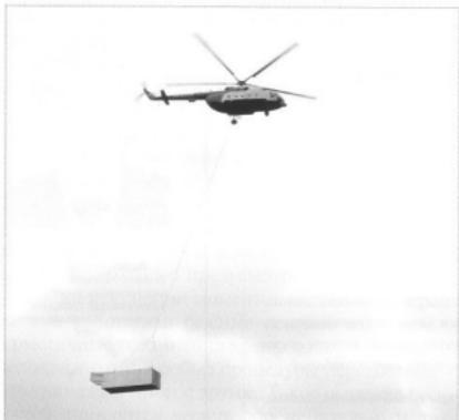
Рис. 1. Вертолетный контейнер быстрого реагирования на внешней подвеске вертолета Ми-8
