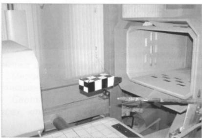
Рис. 2. Модель ВКБР в аэродинамической трубе МГТУ ГА
